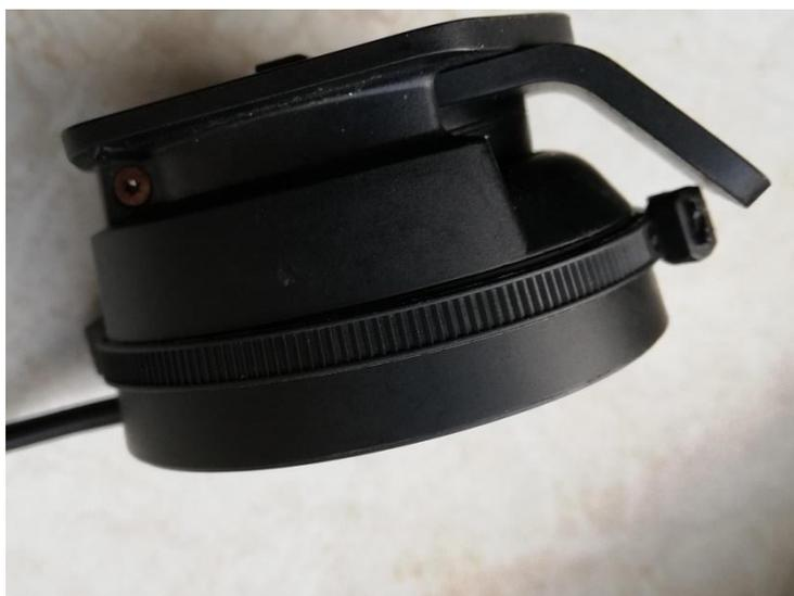
Bevor die Sicherung aktiv wird, den Drehteller vertikal stellen, das Navi einklinken, in die Horizontale drehen und schon ist die Klinke gesperrt, bzw. lässt sich nicht mehr nach unten drücken.
